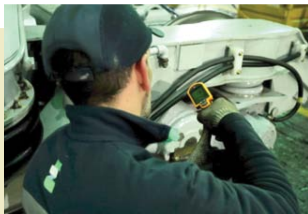
MEDICIÓN LÁSER DE RUEDAS EN TALLERES
